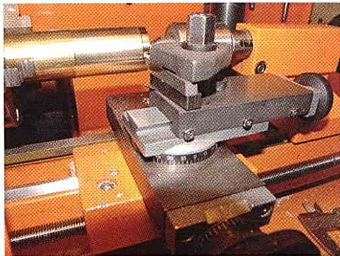
Der Obersupport zum Kegeldrehen.
